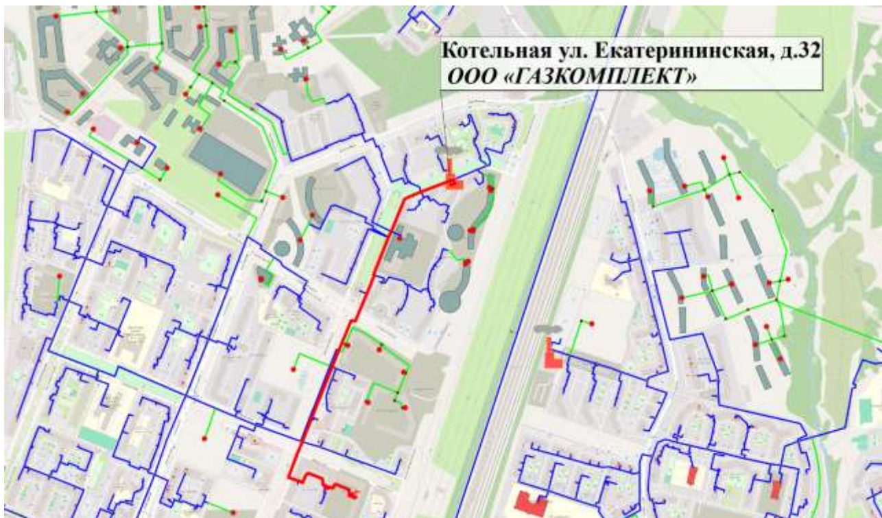
Рисунок 27. Путь для построения пьезометрического графика от котельной ООО «ГАЗКОМПЛЕКТ» Екатерининская 32, стр.1 до перспективного потребителя
