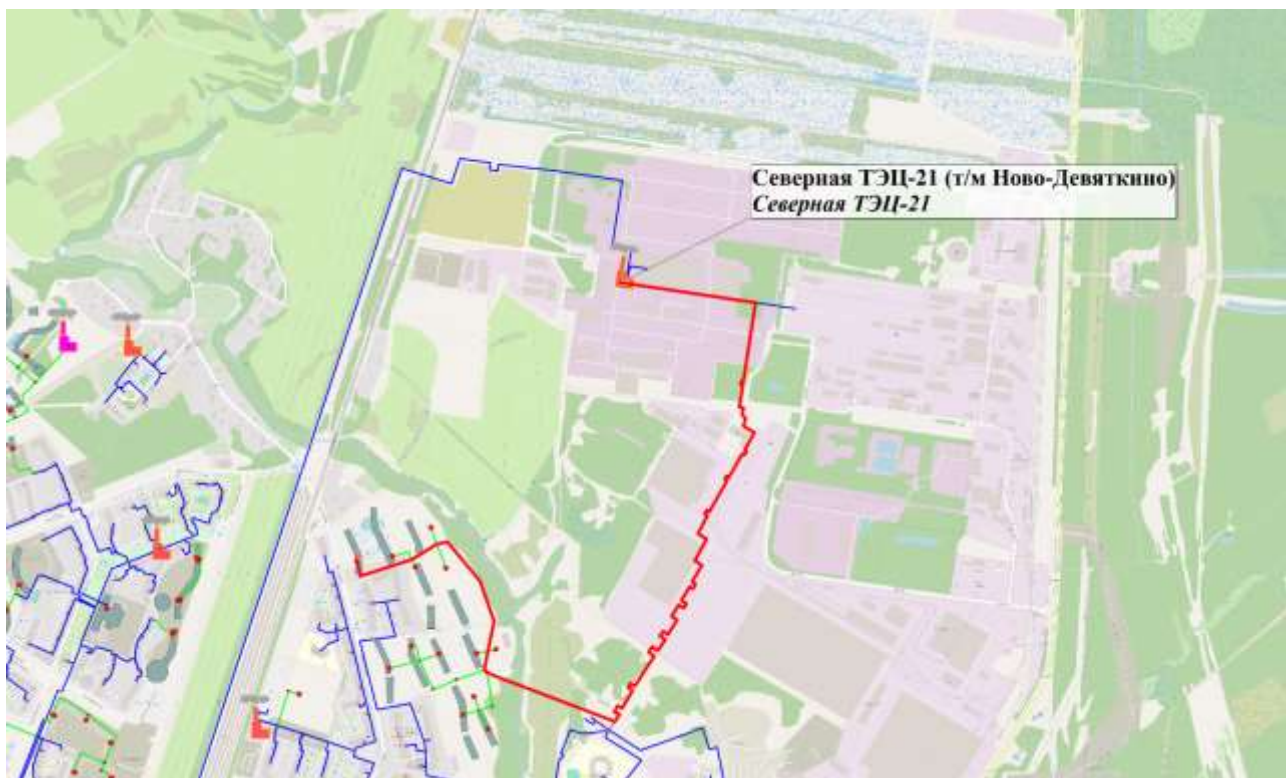
Рисунок 37. Путь для построения пьезометрического графика от Северной ТЭЦ-21 ПАО «ТГК-1» до перспективного потребителя
