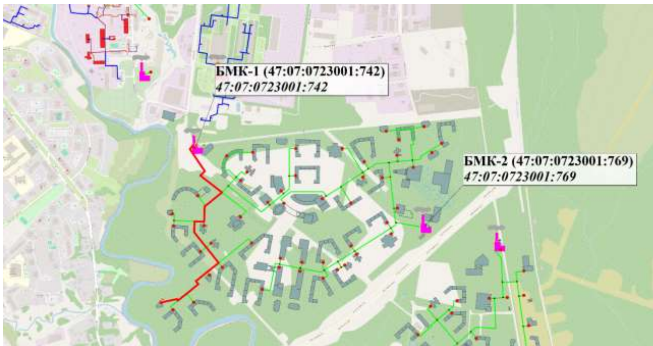
Рисунок 41. Путь для построения пьезометрического графика от БМК-1 (ТК «Мурино») до перспективного потребителя
